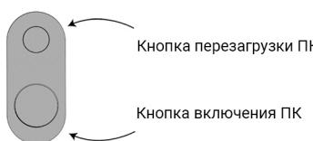
7 Установите коннекторы кнопки перезагрузки и кнопки включения согласно инструкции производителя вашей материнской платы.
